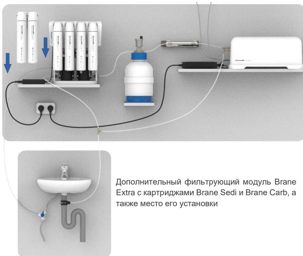
Подключение воды в Brane Extra необходимо производить до основного фильтрующего блока Brane Filter:
