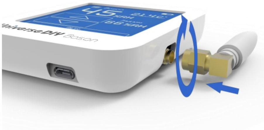
Если зональный пульт находится в комнате, где установлен центральный модуль или между этими устройствами находится не более одной стены, то обычно установка антенны ANT-SMA требуется.
