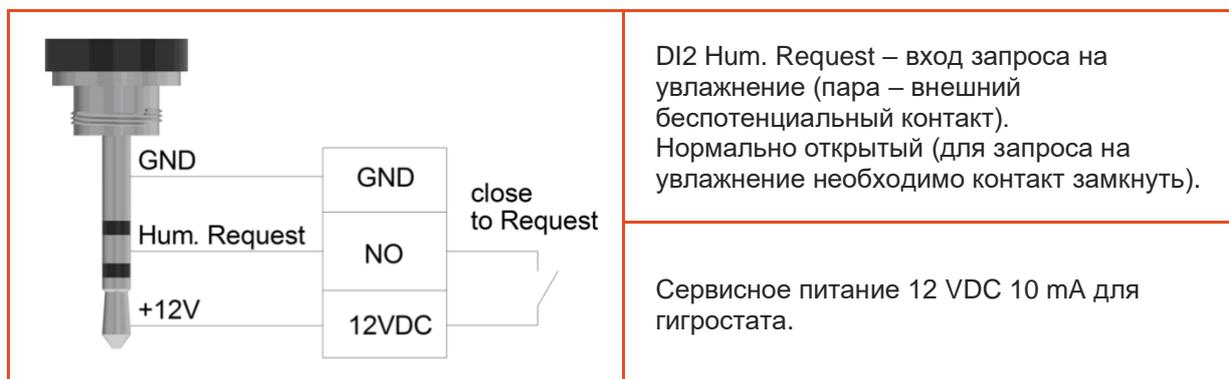
X4 – **ВХОД** разъема стерео mini-Jack с общим проводом, цвет гнезда – **синий**.
